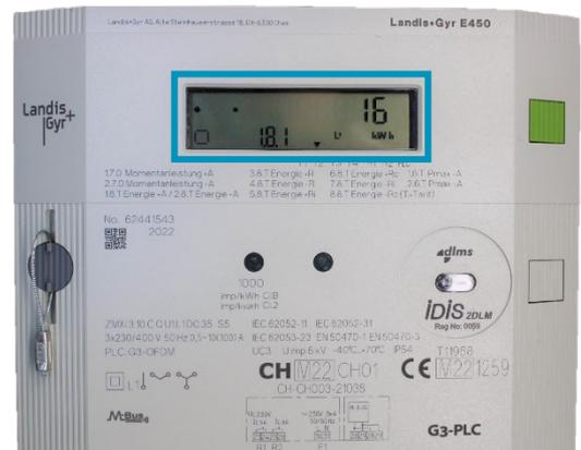
Für die manuelle Abfrage der Messdaten drücken Sie die grüne Taste zweimal, bis «Std\_dAtA» auf dem Display angezeigt wird. Halten Sie die Taste ca. 4 Sekunden lang gedrückt, um alle Messdaten einzusehen. Bei jedem weiteren Drücken der Taste werden die unterschiedlichen Messwerte mit dem entsprechenden Code angezeigt.
